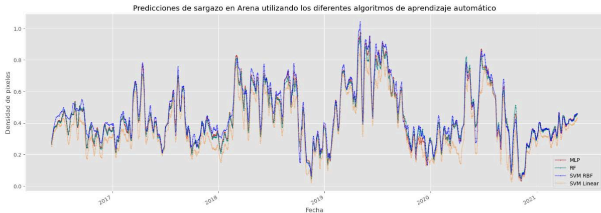
Figura 7.5 Gráfico en donde se pueden visualizar las series de tiempo correspondientes a la cantidad de sargazo detectado con cada uno de los modelos, estas series de tiempo ya se encuentran suavizadas y normalizadas
