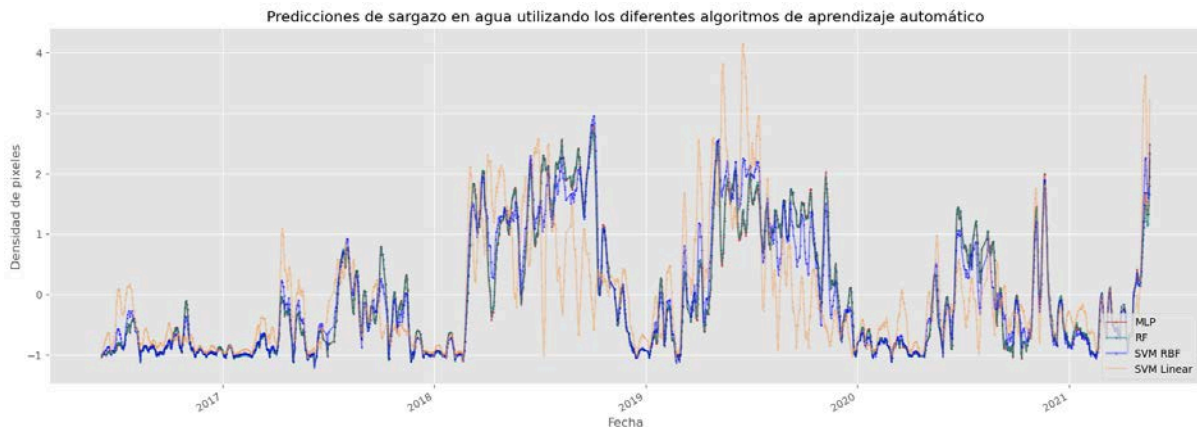
Figura 7.7 Series de tiempo de los cuatro modelos de Aprendizaje Automático entrenados, donde cada uno de los puntos corresponde a la cantidad de pixeles de sargazo detectados.
