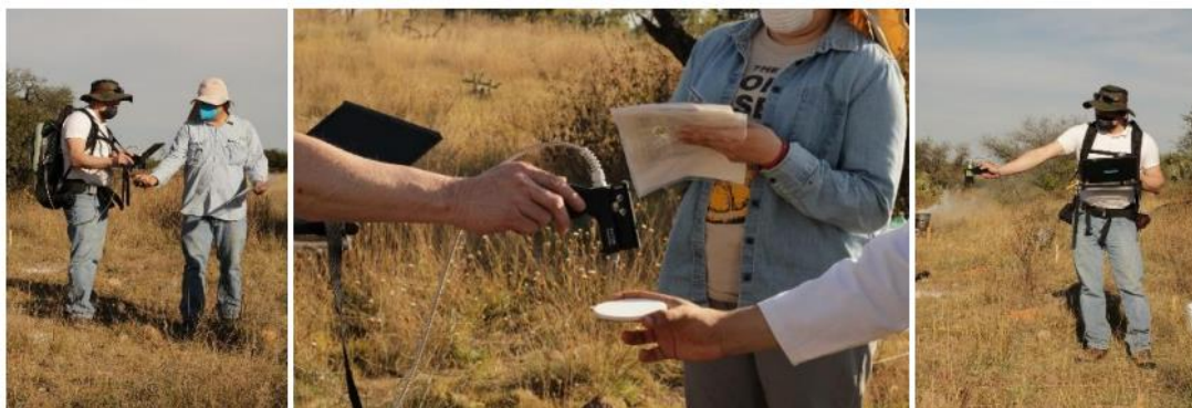
Proceso de calibración y medición de firmas espectrales con espectroradiómetro de campo
